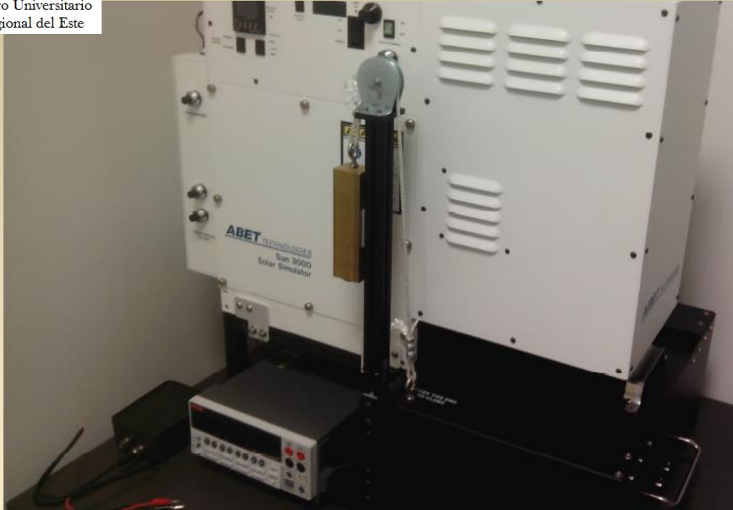
Simulador solar Abet Technologies, SUN 3000, clase AAA. Software ReRa Systems® Tracer2 SMU Keithley-ABET 2410
